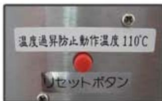
安全の為、過昇防止用安全装置付き。庫内の温度が110度になりますと、安全装置が作動。電源が落ち、リセットボタンがとび出る仕組みになっています。
